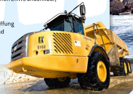
VOLVO A300 Hubraum: 9.400 ccm Leistung: 350 PS Drehmoment: 1.700 Nm Nutzlast: 28.000 kg
